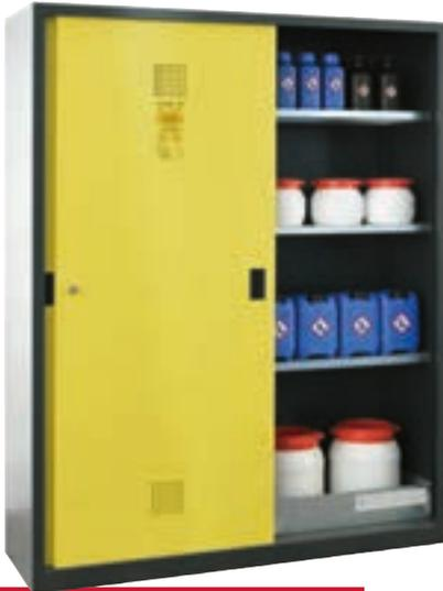
Standschrank zur vorschriftsmäßigen Lagerung von wassergefährdenden, nicht entzündbaren Chemikalien und Giftstoffen in Arbeitsräumen gemäß TRGS 510. Mitteltrennwand, Ebenen kippsicher, im Raster von 20 mm höhenverstellbar. 2 Schiebetüren, Lüftungsanschluss in den Türen, Schloss mittels Griffzylinderschloss verschließbar.
