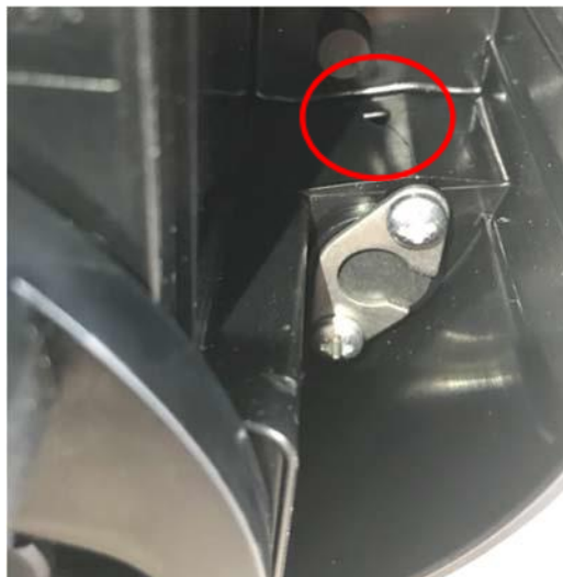
Bild 2. Formfehler (Loch) im explosionsgeschützten Handscheinwerfer der Serie SEB. Das Loch kann unterschiedlich groß sein.
